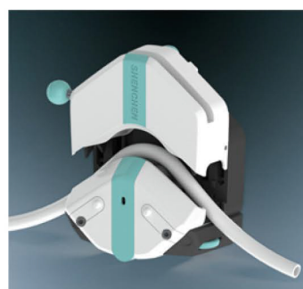
3. 顺时针扳动扳杆 180°，使 压块下压到位，压紧软管。
